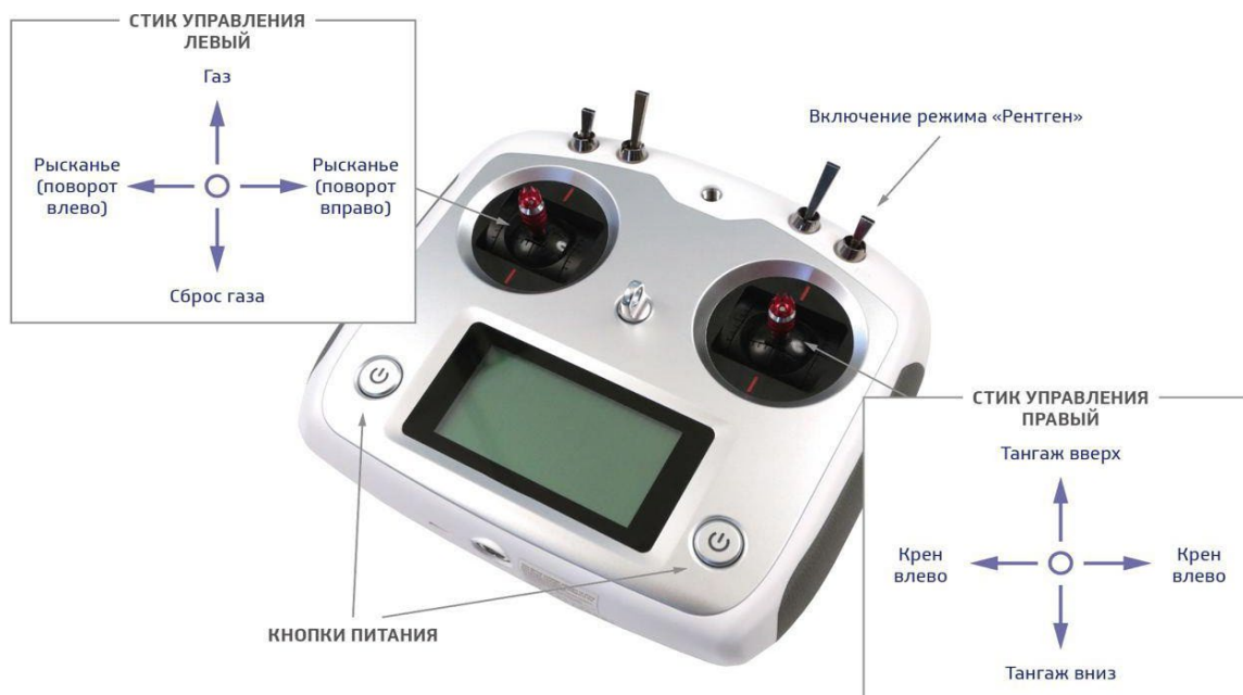
Рисунок 8 – Схема управления БВС в симуляторе с использованием пульта управления FlySky FS-I6S USB
