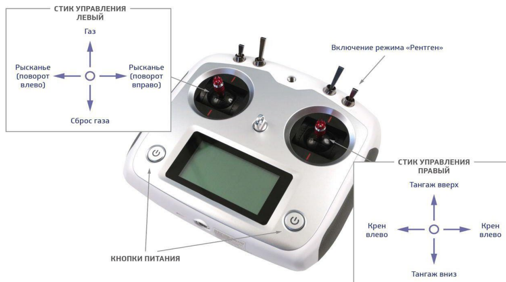
Рисунок 3 – Схема управления БВС в симуляторе с использованием пульта управления FlySky FS-I6S USB
